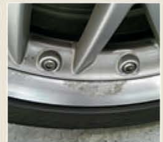
KORROSION Entfernen der Oberfläche, Herausschleifen der Schäden und Auffüllen der Stelle; ab 210 Euro
