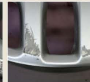
LACKSCHADEN Der Mechaniker schleift die beschädigten Stellen ab und lackiert die Felge neu; ab 100 Euro
