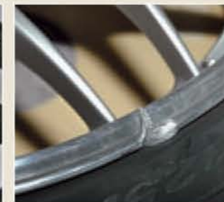
RIEFENSCHADEN Der Schadenverlauf wird genau analysiert und durch Aufschweißen beseitigt; ab 140 Euro
