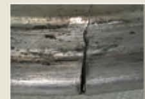
RISS Ein derart schwerer Schaden am Rad gefährdet die Sicherheit – hier hilft keine Reparatur mehr
