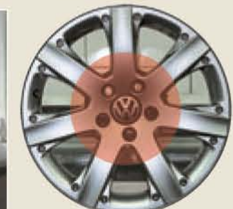
Im roten Bereich ist keine Felgenaufbereitung möglich (weiter als 50 mm vom Rand entfernt)
