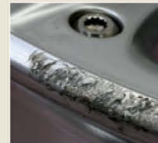
BORDSTEINSCHADEN Die nicht allzu tiefen Macken werden abgeschliffen und nachpoliert; ab 150 Euro
