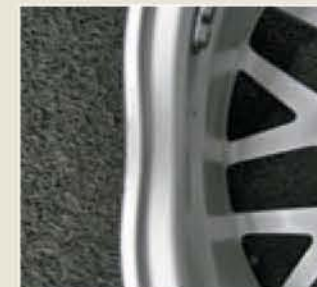
BEULE Das Rad wird erhitzt, rückverformt und erneut temperiert, um Spannungen abzubauen; ab 150 Euro
